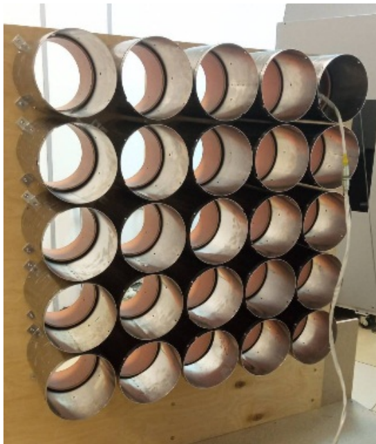
Рис. 1. Макет сборки из 25 экранов для сцинтилляторного детектора спектров нейтрино НИЦ «Курчатовский институт» - ПИЯФ (слева) и результат расчета магнитного поля внутри экранов сборки (справа)
