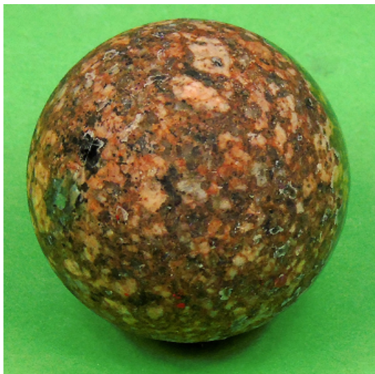
Рис. 1. Сферический образец, изготовленный из гранита рапакиви
